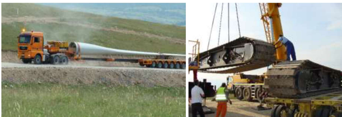
Fig 9 Particularități legate de transportul agabaritic Stânga: elemente modulare ale unei centrale eoliene; Dreapta: transportul pe elemente componente ale macaralei de mare capacitate necesară asamblării turnurilor centralelor eoliene
