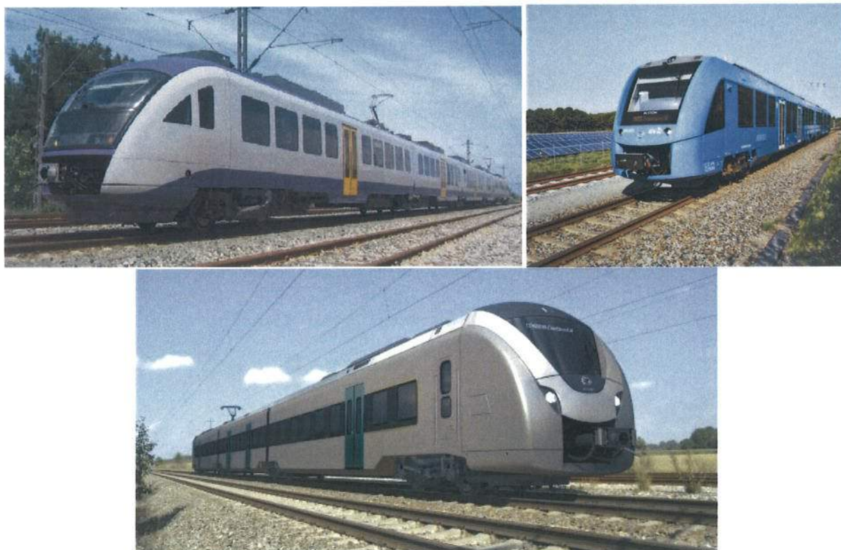
Figura 3.6.2-3 Automotoare (electric, cu hidrogen, tracțiune electrică pe baterii)
