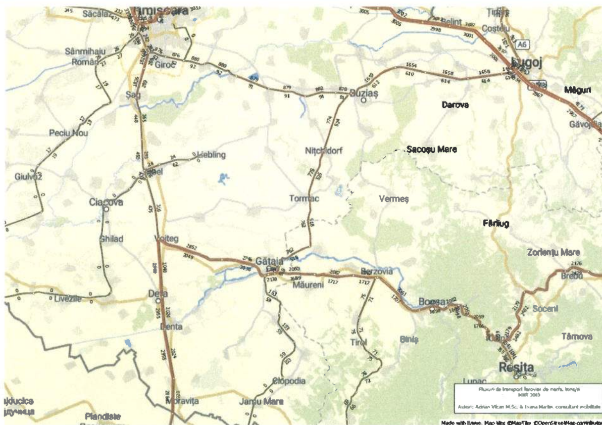
Figura 3.6.1-8 Fluxuri de transport de marfă pe calea ferată, MNT 2018 actualizat – tone pe zi, sectorul Voiteni – Reșița Nord
