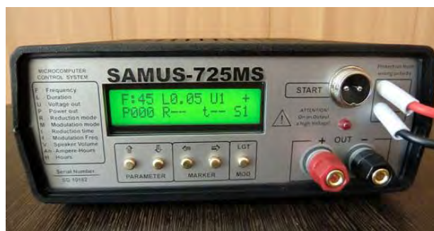
Foto 140. Aparatul de electronarcoză Samus 725 MS utilizat pentru pescuitul științific S-a încercat o cât mai bună acoperire a zonelor studiate, accentuându-se cercetarea zonelor de mal, unde ihtiofauna este mai bine reprezentată numeric, dar și ca diversitate a speciilor.
